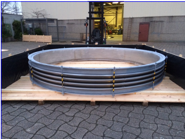
Roestvrijstalen compensator DN4000 voor een cementfabriek, inwendig voorzien van een binnenbus en isolatie in de golven (om stofophoping tegen te gaan).
