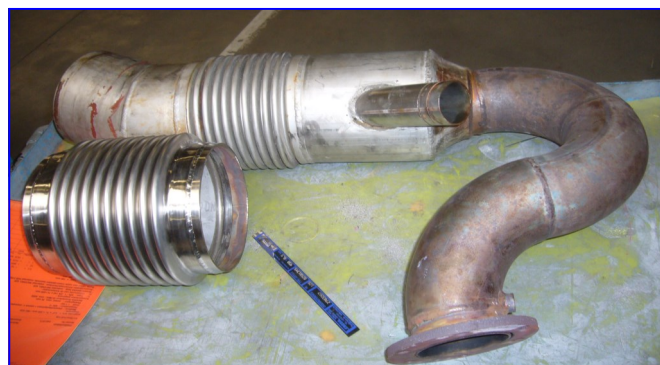
Systeem van 3 scharniercompensatoren om grote uitzettingen van het leidingwerk op te vangen, zonder drukreactiekrachten te genereren. Dergelijke oplossing is ideaal voor opgehangen leidingen, waar de mogelijkheid om stevige verankeringen te voorzien vaak niet bestaat.
